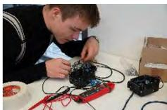
Handwerklich ging es zu beim Bau von Open Bike Sensoren zur Messung des Überholabstands von Kraftfahrzeugen im Straßenverkehr. Aus vielen Einzelteilen wurden 10 Geräte zusammengesetzt, die demnächst zum Einsatz auf den Jenaer Straßen kommen sollen. Mit den Messungen werden Daten generiert, die auf einer Karte dargestellt werden und von der Stadt zur zielgerichteten Anordnung von Maßnahmen genutzt werden können.
